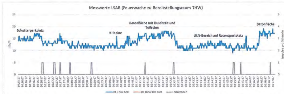
Abb. 10: Messung mittels LSAR von der Feuerwache auf dem Gelände der WTD zum Bereitstellungsraum des THW, ebenfalls auf dem Gelände der WTD. Hier wurden die sanitären Anlage und Unterkunftsbereiche abgefahren (soweit zugänglich). Zudem erfolgte vor dem Zugang zu den Duschen eine Bodenprobenahme (vgl. 3.3 ff.).
