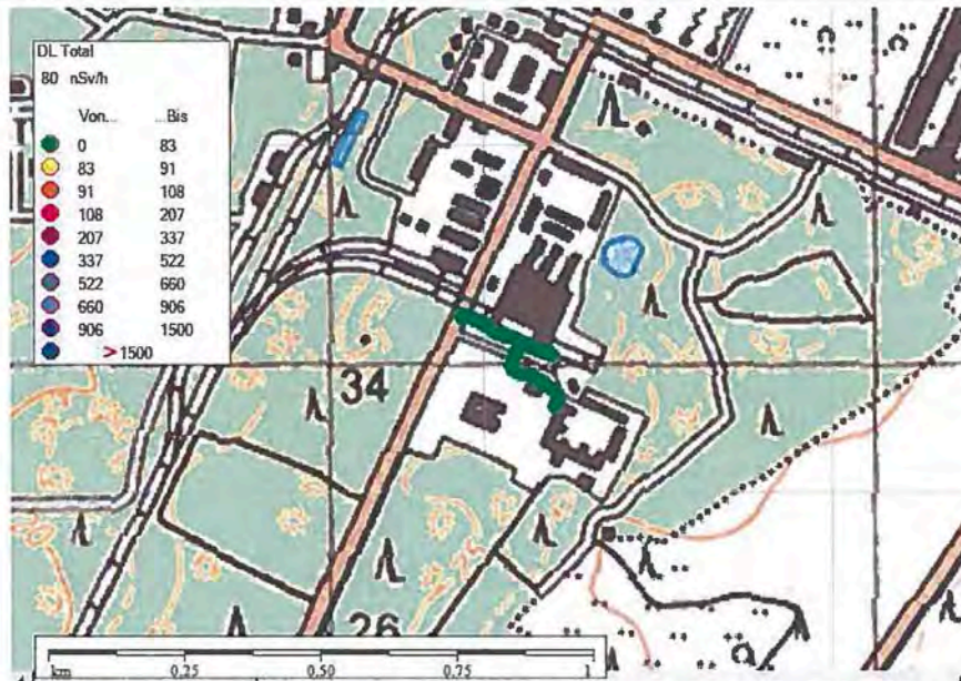
Abb. A7: Messung Bereitstellungsraum des SpezPiRgt 64, Unterkunfts- und Sanitärbereiche.
