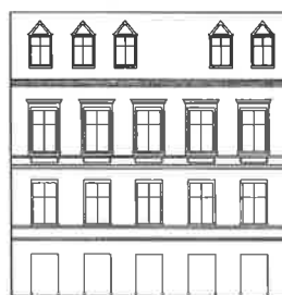
Negativ: Gaubeanordnung ohne Bezug zu Fensterachsen, der Abstand der rechten Gaube zum Ortgang ist geringer als der des äußeren Fensters im obersten Geschoss
