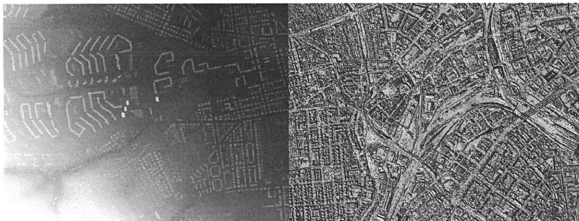
Abbildung 4: Laserscan-Oberflächenmodell (Dresden)
