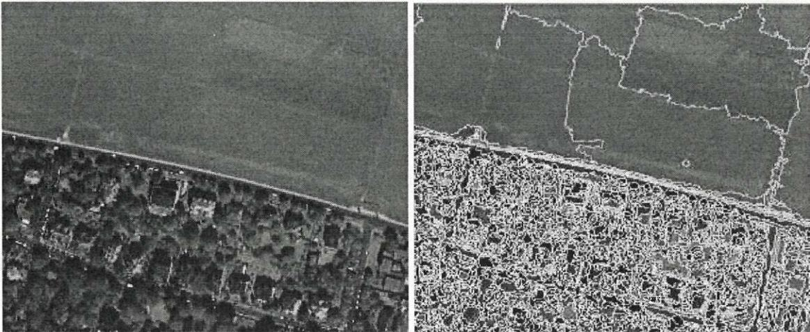
Abbildung 86: Darstellung des Ausgangsdatensatzes (links, Kanalkombination 4/3/2) und optimierte Segmentierungsebene (rechts).
