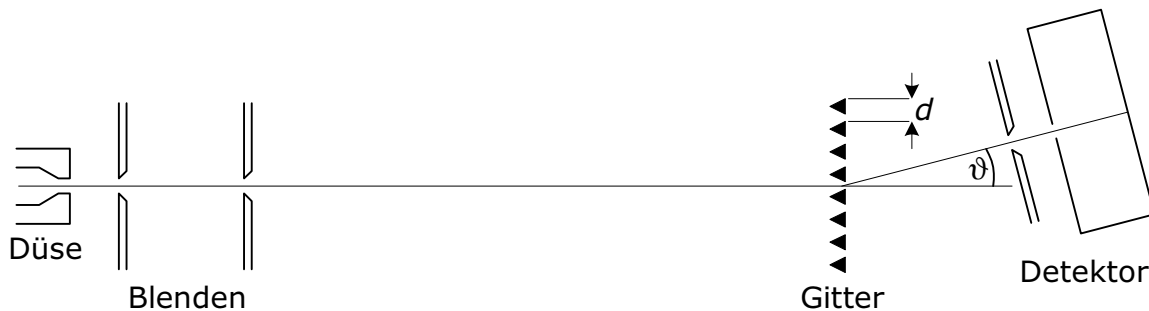
Abb. 2 schematischer Versuchsaufbau; Abstand der Gitteröffnungen d = 100 \text{ nm}
