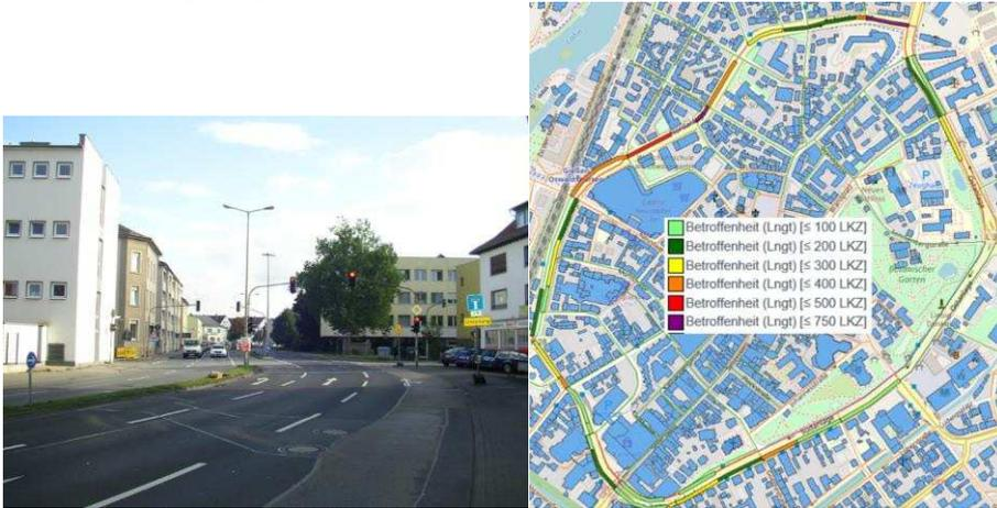
Abbildung 2: Typische Wohnbebauung am Anlagenring (links) und Visualisierung des Lärmkonfliktpunktes durch farbige Bänder der normierten Lärmkennziffern.<sup>23</sup>
