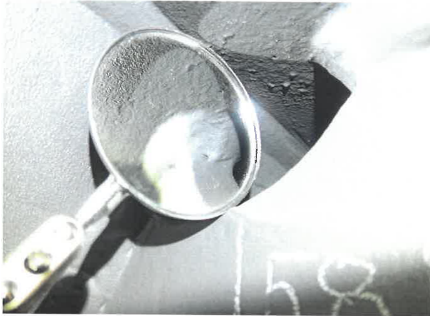
Bild 7 (Prüfpunkt 58 mit zur Oberfläche hin offener Pore im Be- reich der Um- schweißung)
