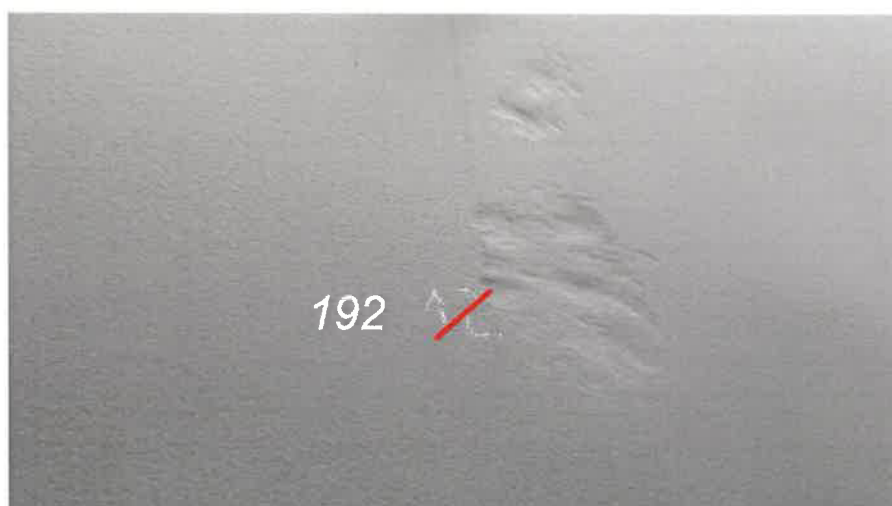
Bild 222 (Übersicht Prüfpunkt 192 mit tiefen Schleifkerben unterhalb des Laschen- blechs)
