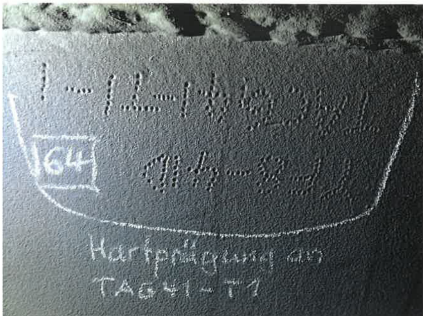
Bild 21 (Prüfpunkt 64 - Hartprägung am Quer- schottblech TAG41-T1)
