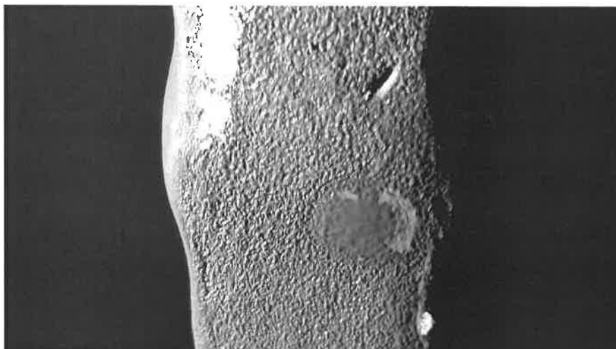
Bild 113 (Detail Prüf- punkt 113 - Nahtende mit linearer An- zeige - nicht erfasste Kan- te)
