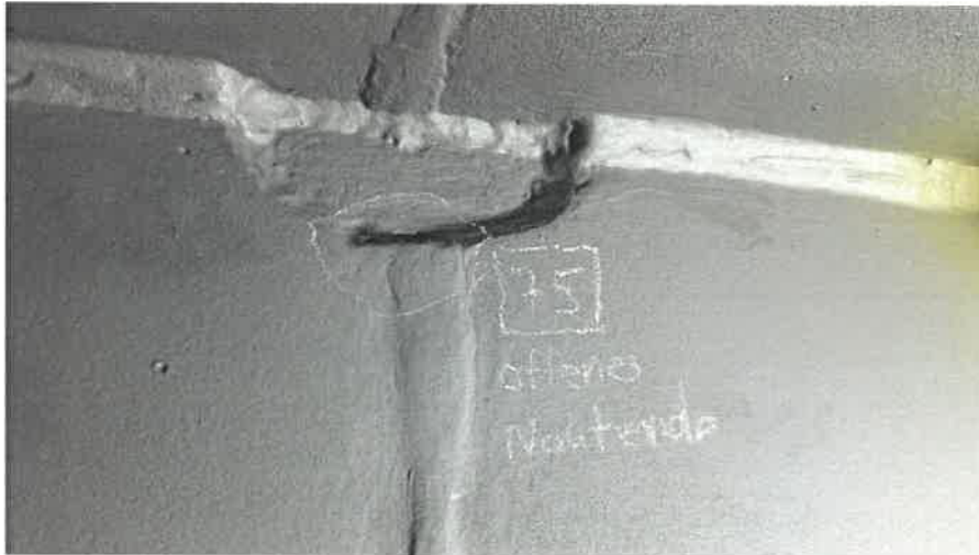
Bild 46 (Prüfpunkt 75- Fehlstelle am Nahtende im Übergang zum einge- setzten Paß- stück mit geringerer Blechdicke)
