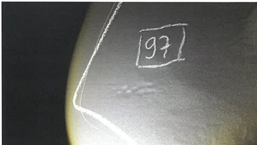
Bild 83 (Prüfpunkt 97- mechanische Eindrücke - Pressenan- satzpunkte?)
