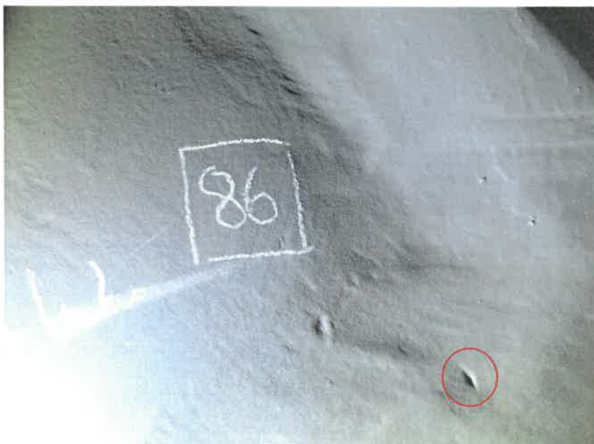
Bild 69 (Detail Prüf- punkt 86 mit Unterschlei- fung und ei- ner scharf- kantigen Kerbe)
