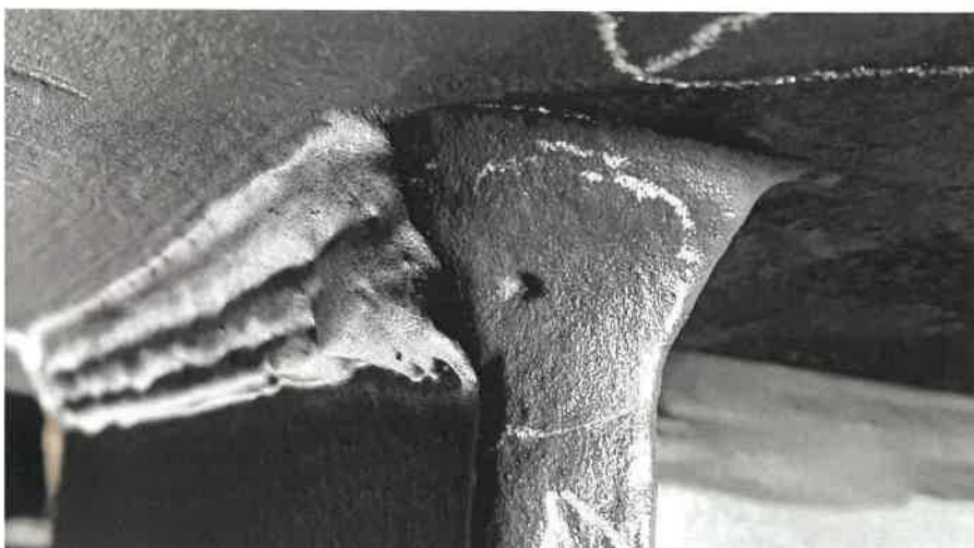
Bild 99 (Detail Prüfpunkt 106 mit der zur Oberfläche hin offenen Pore)
