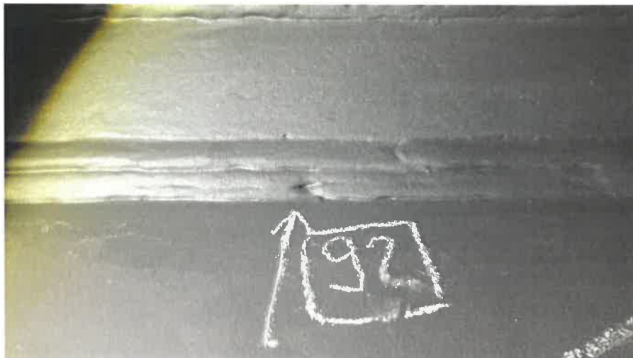
Bild 77 (Prüfpunkt 92 – scharfe Kerbe zwi- schen den Raupen)
