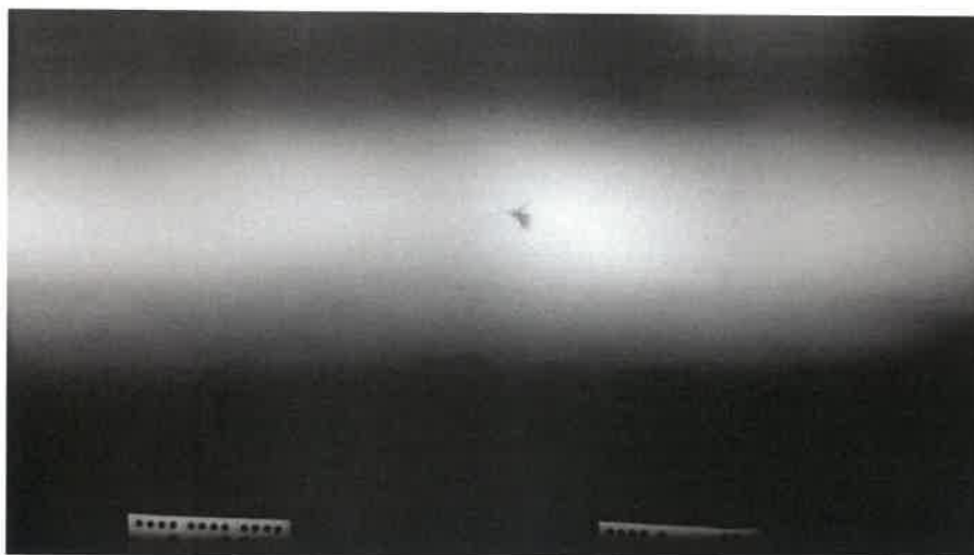
Bild 15 (wie Bild 14, jedoch Detail scharfkanti- ger Schla- ckenein- schluß)
