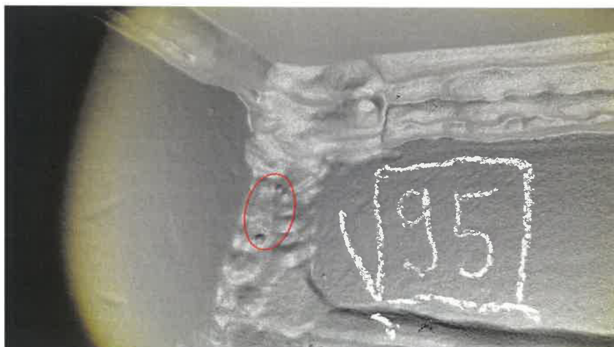
Bild 81 (Prüfpunkt 95- Freischnitt zugeschweißt, sowie ange- schmolzenen Schweiß- spritzern)
