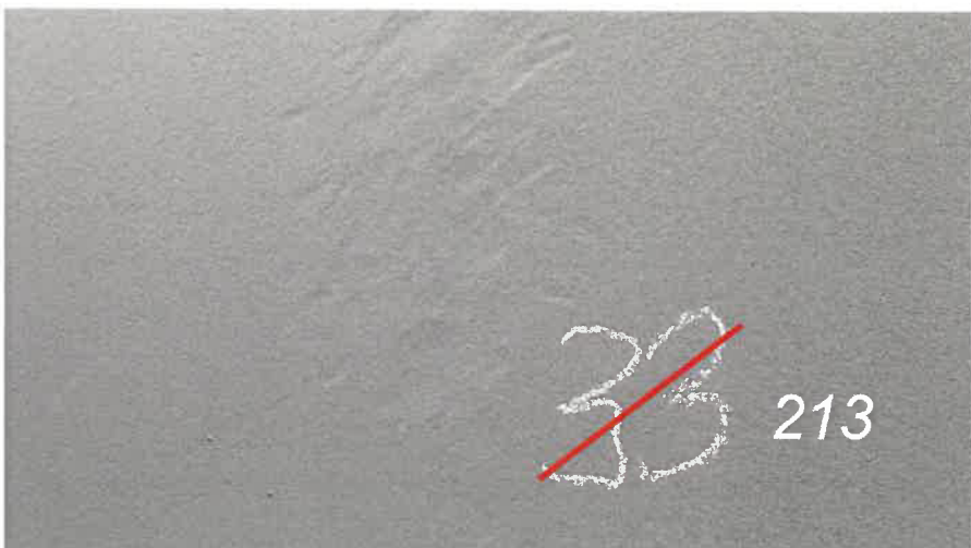
Bild 234 (Prüfpunkt 213 – Schleif- kerbe in der Oberfläche von W1)
