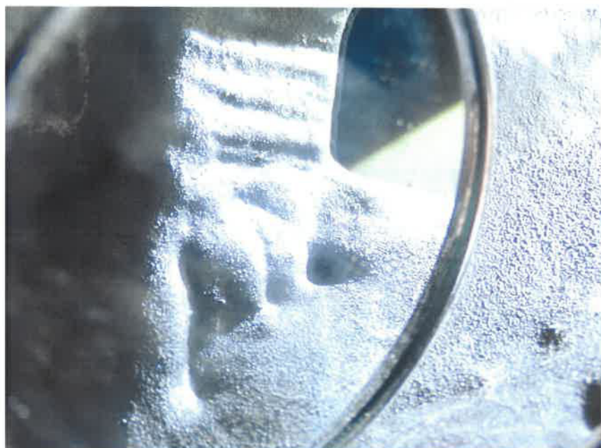
Bild 30 (Prüfpunkt 67 – nicht voll- ständige Um- schweißung mit offener Hohlstelle in der Schweiß- naht und mit nicht bearbei- teter Brenn- schnittkante. Bild über Spiegel auf- genommen.)
