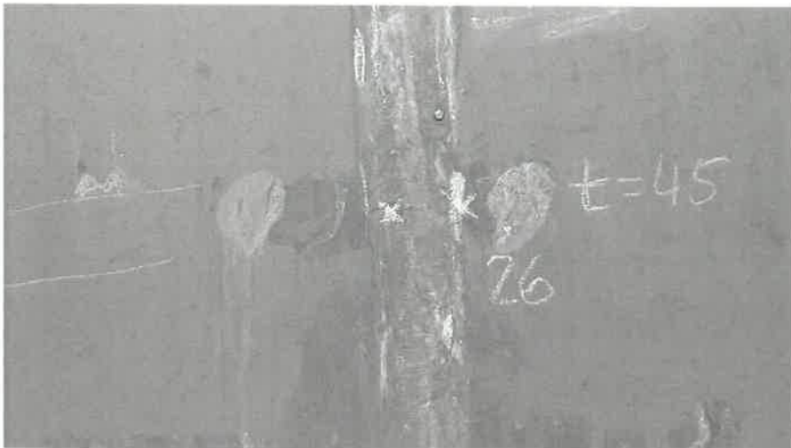
Bild 233 (Detail Prüf- punkt 206 mit Schleifkerben auf der Ge- genseite der des Schott- blechan- schlusses TAG 127 in W1)
