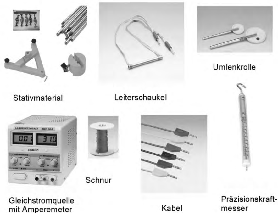
Abbildung 2: Experimentiermaterial zur Messung der magnetischen Feldstärke
