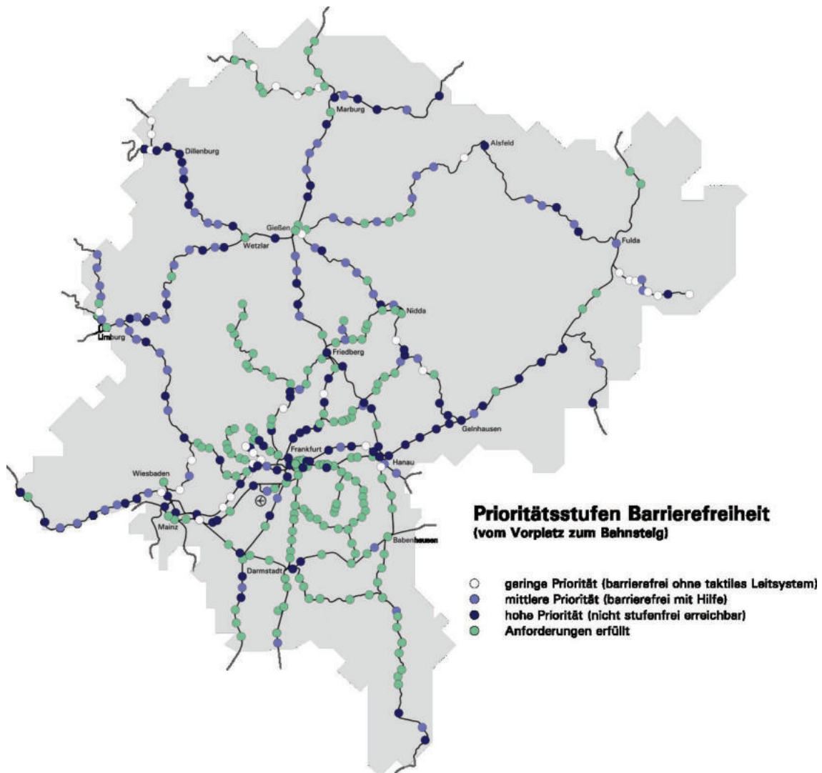
Abbildung 105: Prioritätsstufen für den barrierefreien Ausbau (Zugang Vorplatz/Straße – Bahnsteig) der Stationen im RMV-Gebiet
