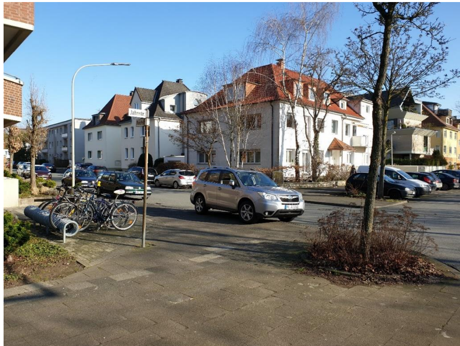
Abbildung 12: Selten genutzter Spiral-Vorderradhalter. Dieser Anlagentyp sollte nicht mehr zum Einsatz kommen und ersetzt werden.
