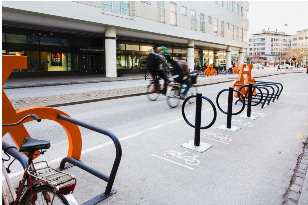
Abbildung 5: Fahrradabstellanlage mit gesonderten Stellplätzen für Lastenräder/Sonderräder (Malmö). (Foto: Eigene Aufnahme)
