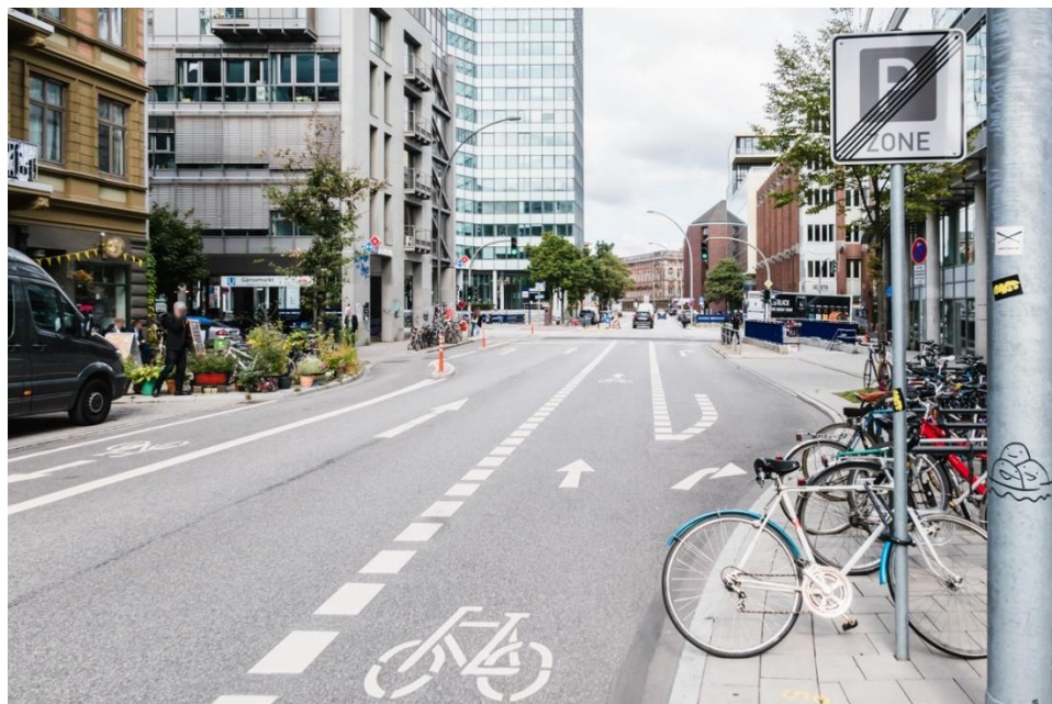
Abbildung 2: Radfahrstreifen in Mittellage ("Fahrradweiche") Bsp. Hamburg (eigenes Foto)
