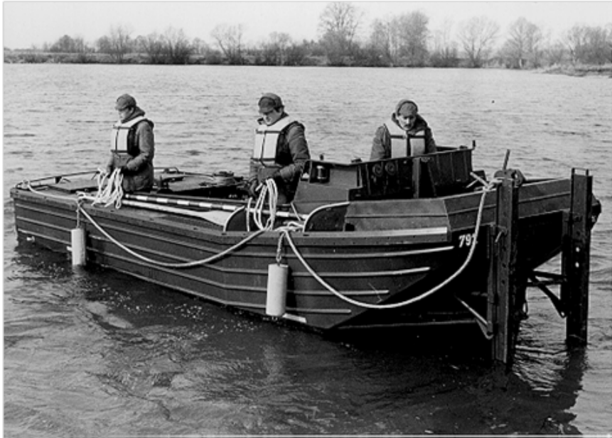
Abb. 22 - Motorboot, fertig zum Aufnehmen eines schwimmfähigen Landfahrzeugs an Steuerbord (Beispiel: Motorboot, klein)
