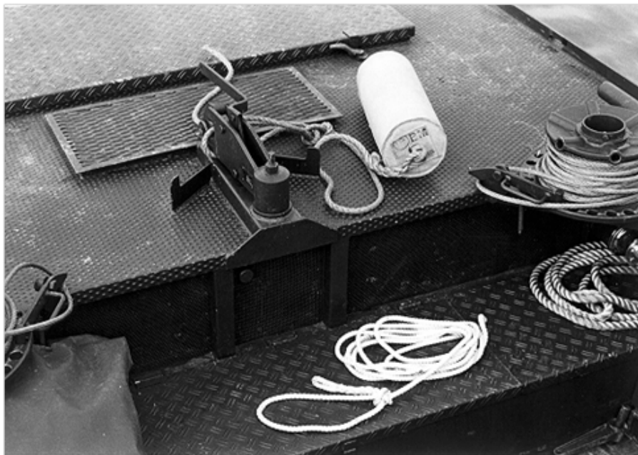
Abb. 20 - Bereitliegender Fender und bereitliegende Bindeleine (Beispiel: Motorboot, klein)
