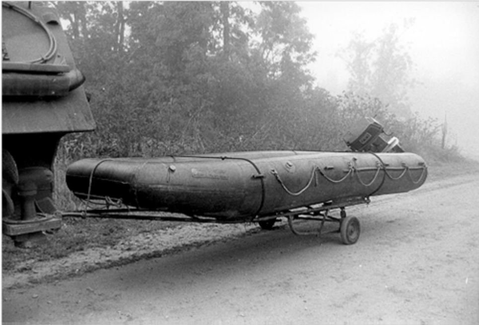
Abb. 118 - Großes Schlauchboot auf Transportachse verlastet, angehängt an TPz Fuchs
