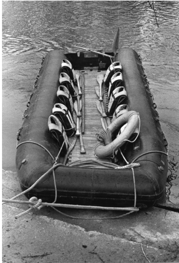
Abb. 18 - Großes Schlauchboot als Rettungsboot ausgerüstet
