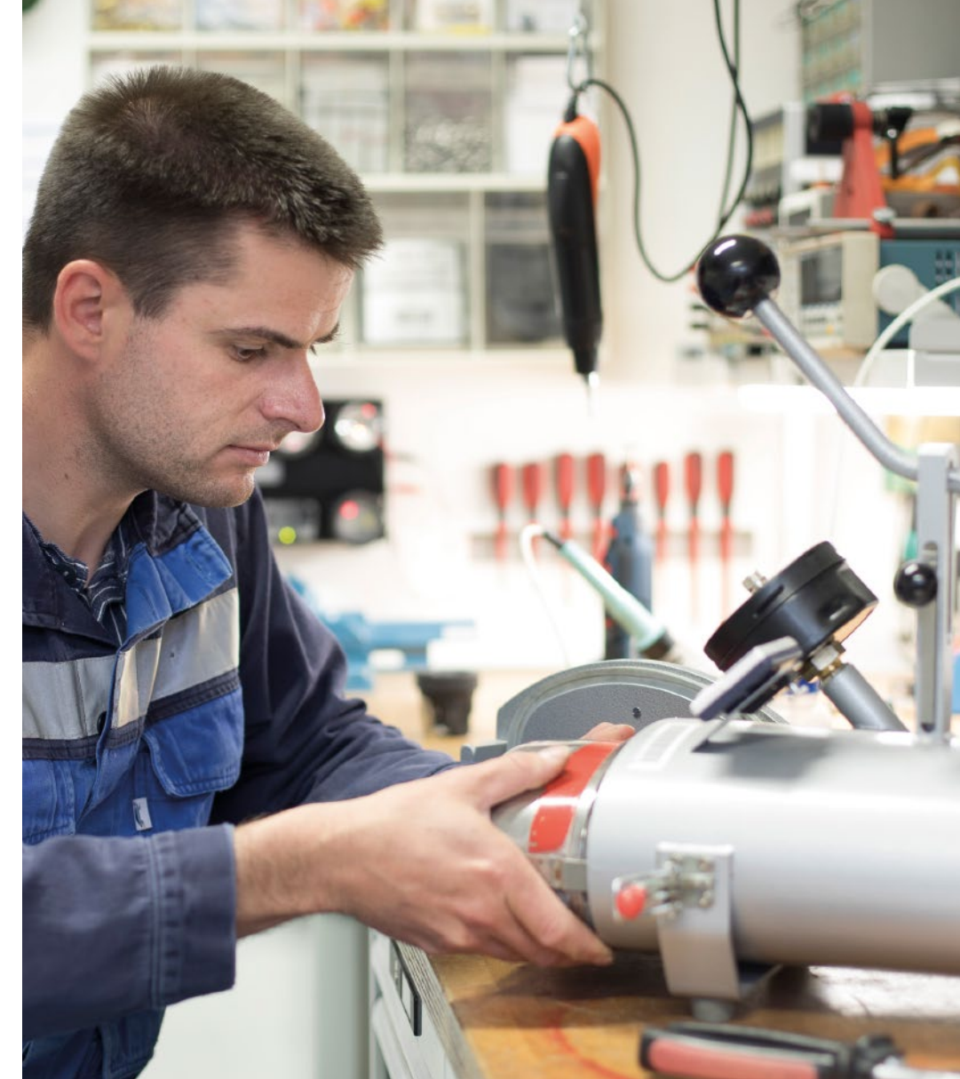
Marvin Kögel bei der Überprüfung der Sauerstoffselbstretter (Schachtanlage Asse)
