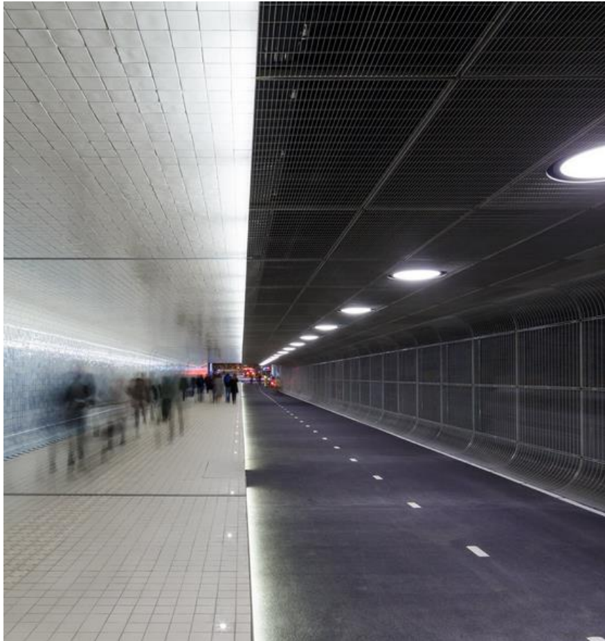
Licht- und Farbtrennung Radweg und Fußweg in der Unterführung am Beispiel Bf. Amsterdam Centraal
