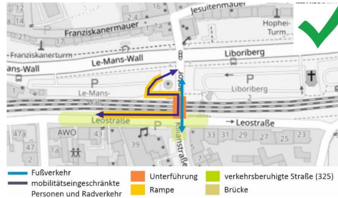
Variante 2 – Unterführung mit Rampe auf der Leostraße
