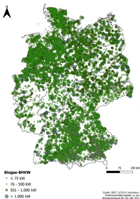
Abbildung 1: Regionale Verteilung der Biogas-BHKW (VOV) differenziert nach installierter elektrischer Leistung; Datenbasis: ÜNB-Daten zur Stromerzeugung aus Biomasse, 2021 (Bezugsjahr 2020)
